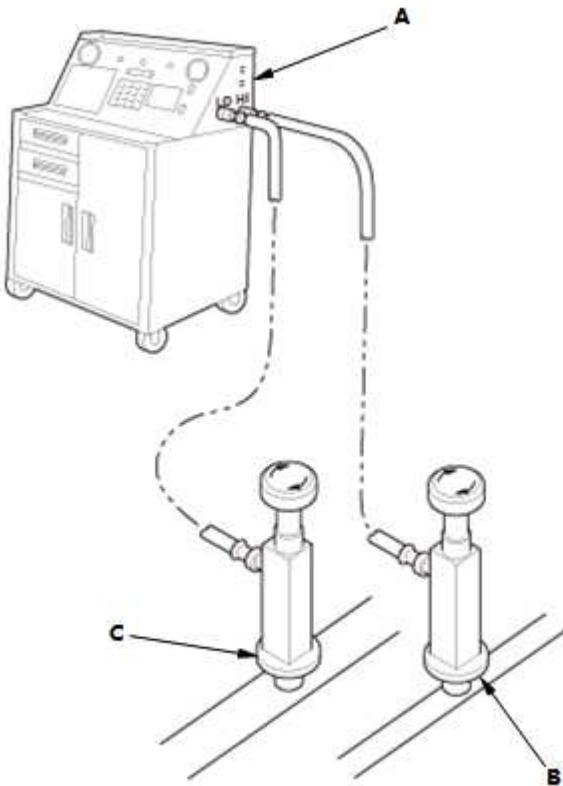
1. 如图所示，遵循设备制造商的说明，将一个 R-134a 制冷剂回收/循环/加液站 (A) 连接到高压检修口 (B) 和低压检修口 (C) 上。
